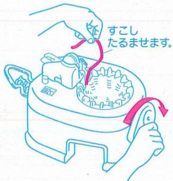
毛糸がはずれない部分があったら、マガジンをはずして、図の位置で、とじ針ではずしてください。
