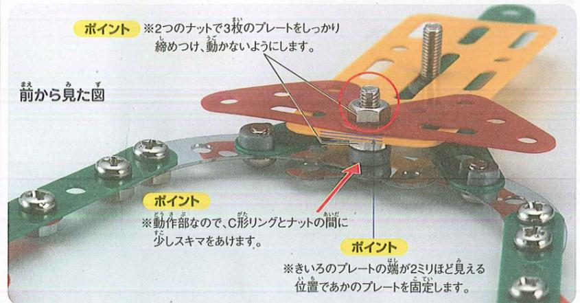
**ポイント** ※2つのナットで3枚のプレートをしっかり締めつけ、動かないようにします。
