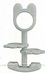
キャットツリーパーツBを使う時は支柱の溝にあわせてパーツを通し、溝と溝の間で回転させて使います。
