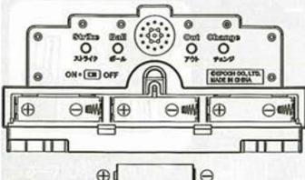
1. プラスドライバーを使って、電光掲示板裏面にあるネジを外し、電池プタを開けます。
